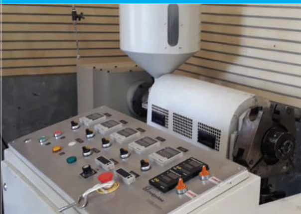
دستگاه اکسترودر تک ماردرنه نسبت طول به قطر ۲۰ و حداکثر دور ماردون ۵۰ دور بر دقیقه
