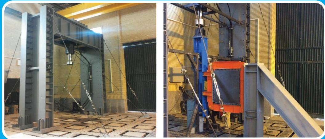
تصویری از یک نمونه دیوار برشی فولادی در حین تست (steel plate shear wall test)
